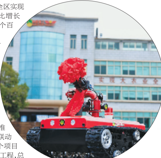
宁波奔野重工股份有限公司自主研发的履带式消防机器人
