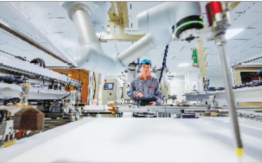
作为浙江省首批公布的96家“科技新小龙”企业之一，位于长兴的浙江奥飞芯材科技有限公司专注高选择性渗透长效分离膜材料的研发与产业化。图为工人操控全自动膜材料生产线。
