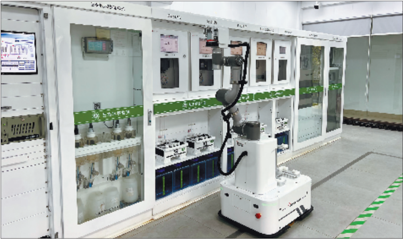
机器人进行设备巡检。
