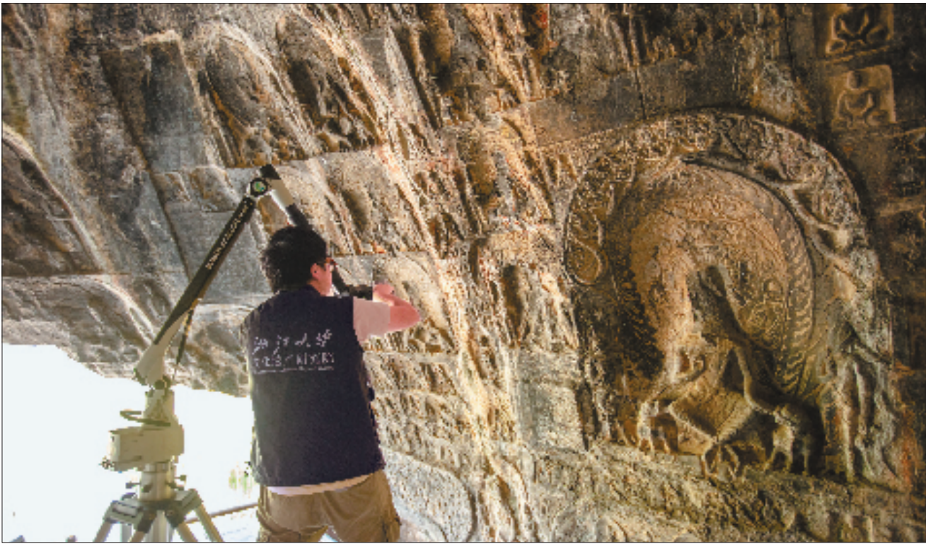
浙江大学艺术与考古图像数据实验室学生在龙门石窟古阳洞进行三维激光扫描。
