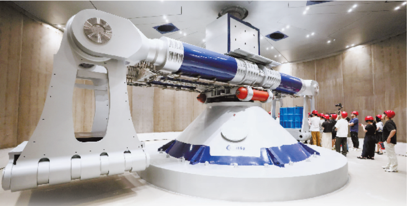
超重力离心模拟与实验装置启动的首台离心机主机“CHIEF1300”。 本报记者 魏志阳 姚颖康 摄
