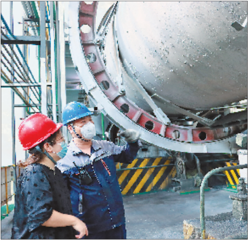
记者(左)跟随巡检员韩利鹏在回转窑下方检查托轮等设备。 通讯员 周洪慧 摄
