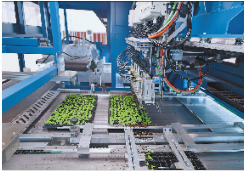
谢径安·传化农创村里的全自动移苗补苗机械设备。
