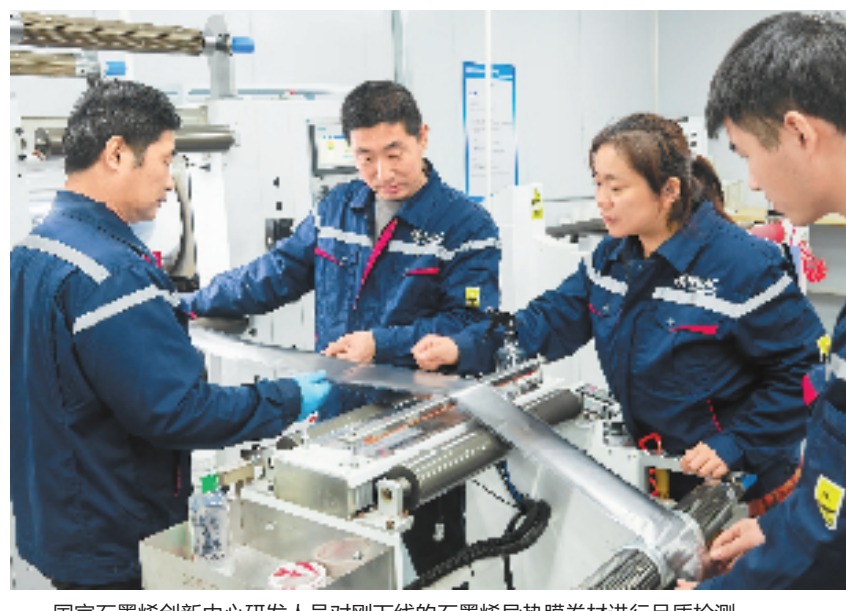
国家石墨烯创新中心研究人员对刚下线的石墨烯导热膜卷材进行品质检测。 国家石墨烯创新中心供图
