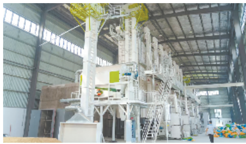
在祝良村“粮食共富驿站”,11台稻谷烘干机烘干能力达220吨。(图片由南浔区旧馆街道提供)
