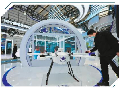
全球首款百公里级氢动力长航程多 旋翼无人机,也是全球首款集成降落伞 设计的量产型氢动力无人机。空机重量 19公斤,最大挂载重量6公斤,最大续航 近4小时,主要性能和产品设计达到行
