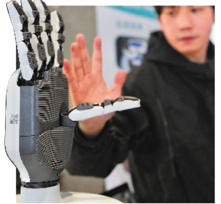
具有19个自由度的工业级量产 五指三关节灵巧手,内置23个传感 器,可通过拍摄和穿戴设备实现单手 玩魔方、一手抓多物、使用常用工具等 功能,兼具可靠性、高集成、强兼容、易 维护、低功耗、多模态等特点。研发公
