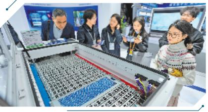
巨化集团下属巨冷科技成功研发 了含氟冷却液、液冷热管理设备、液冷 服务器,形成单相浸没式液冷数据中心 设计、建设、交付能力。通过将服务器、 网络设备等设备完全浸没在热管理设
