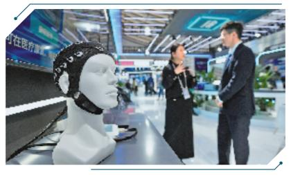
由中国电子信息产业集团旗下的 中电云脑(天津)科技有限公司研发,可 提供覆盖"刺激—采集—分析"的脑机 接口全链条核心功能,支持视觉、听觉、 触觉多模态事件刺激,为脑机接口产品 大规模应用提供重要支撑。事件相关 电位仪进行刺激时,患者大脑皮层会产
