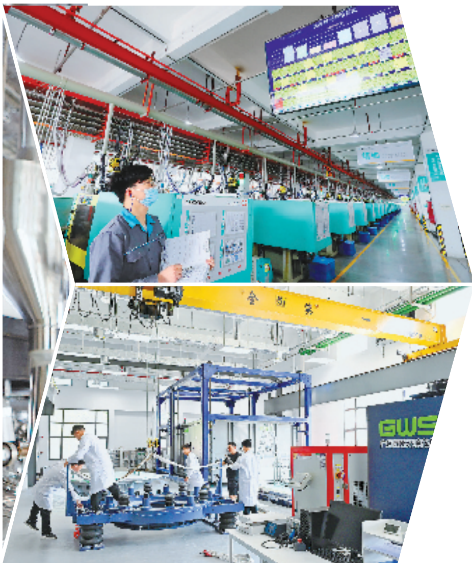
上图:浙江珠城科技股份有限公司的注塑车间。 下图:中国赛宝(东南)实验室的工程师们对40吨振动台进行“倒台”培训,以提升实验产品在复杂、多变环境下的可靠性。共享联盟·乐清 刘言勇 摄
