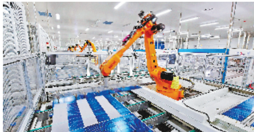
位于金华的润马光能是2023年浙江“千项万亿”重大项目之一。图为近日在公司一期2GW光伏组件智慧工厂里，机器人正在高速作业。
