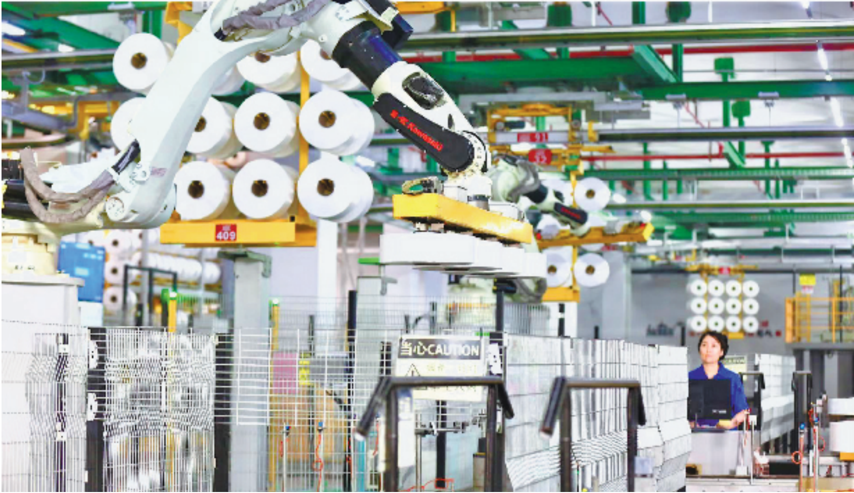
位于桐乡市洲泉镇的桐昆集团“未来工厂”车间里,机械臂正轻巧地搬运丝饼。
