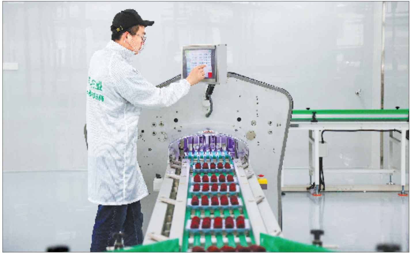
近日，青田县新投用的杨梅智能分拣中心正式启用。该中心构建了从预冷、分拣到包装、仓储的一体化智能处理体系，有效解决杨梅保鲜期短、易损耗的行业痛点。
