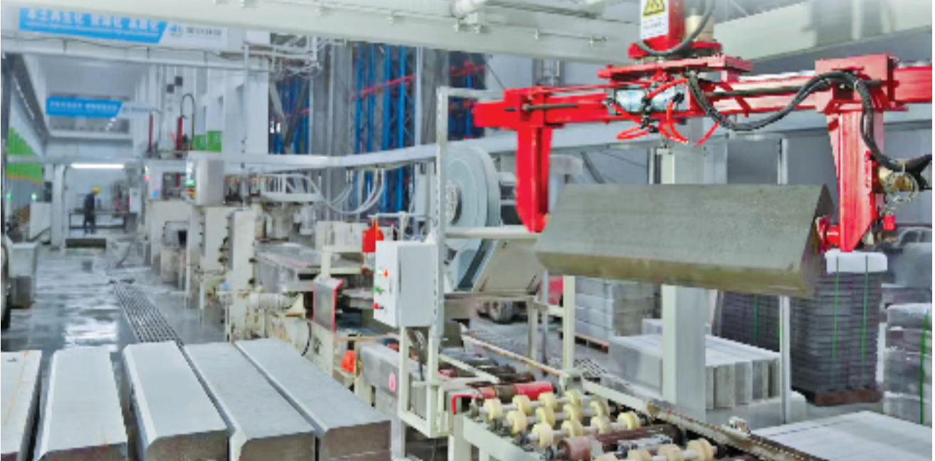
左下:记者(右)在生产车间核验无机生态石尺寸。通讯员 吴昱焱 摄 右图:自动化设备对生态石成品进行切割、磨抛加工。受访者供图
