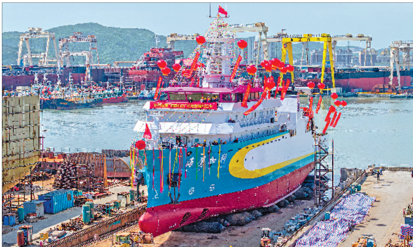
5月5日，国内首艘完全由民资建造的科考船在温岭市松门镇下水。这艘名为“海鹰加科”号的科考船由37名渔民集资1.5亿元建造，船长82米，满载排水量3500吨，续航力达1万海里，自持力大于60天，可奔赴远海及极地周边开展各类海洋科考作业。
