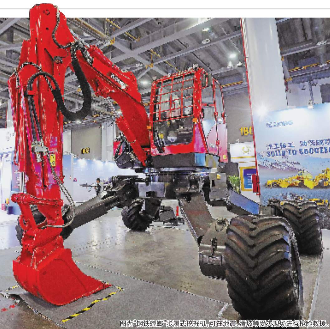
图为“钢铁螳螂”步履式挖掘机,可在地震、滑坡等受灾现场进行抢险救援。
