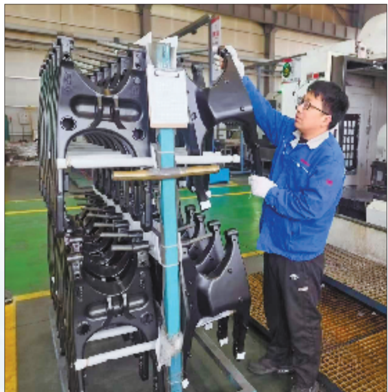
4月10日,绍兴新昌的万丰奥特控股集团下属子公司——威海万丰镁业科技发展有限公司车间内,工人们正在加工为张雪机车配套的摩托车车架。
