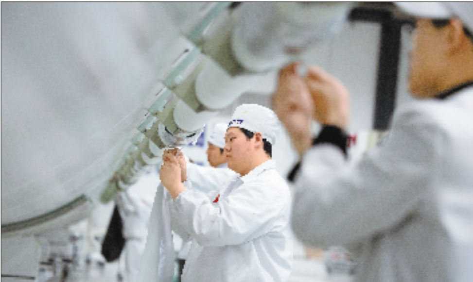
技术人员正在包缚火箭箭体外围管路。
