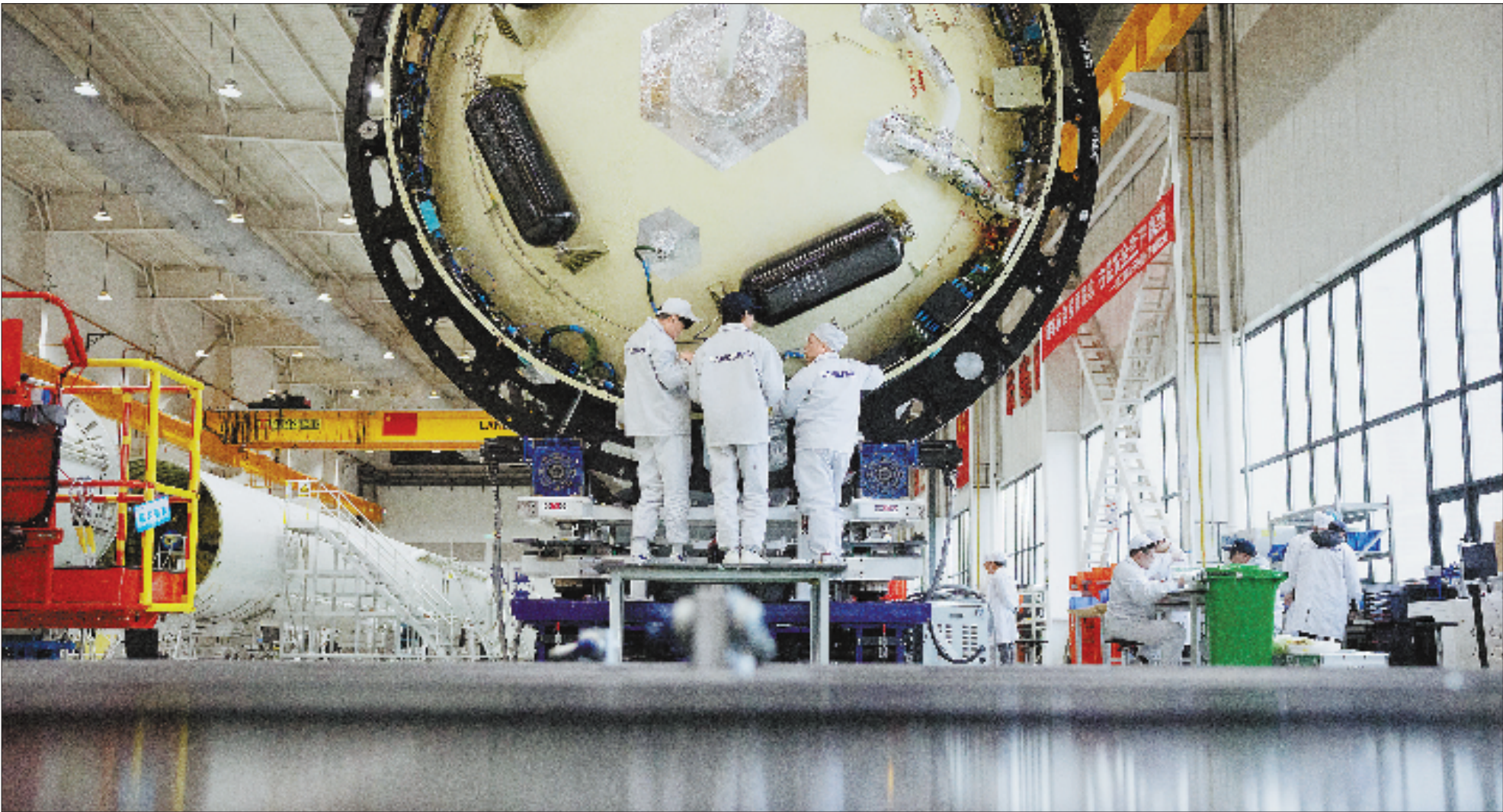
总装车间内,装配人员正在检测朱雀三号二级管线。
