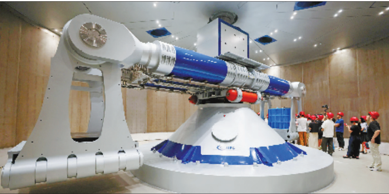
9月29日,由浙江大学牵头建设的国家重大科技基础设施——超重力离心模拟与实验装置(杭州超重力场)启动首台离心机主机“CHIEF1300”。(资料图片)
