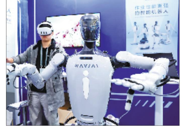
它是搭载固定场馆知识库的智能互动机器人，身高1.65米，体重60公斤，具备41个自由度，末端算力约275TOPS（万亿次每秒），内置场馆概况、展区分布、展品背景、参观指南等核心信息，不仅能用清晰语音解答观众疑问，还会在说话时搭配自然手势；介绍场馆布局时会模拟说话动作，让枯燥的信息变得生动直观。作为行业首个全自由度、全尺寸、有精确技能作业能力的人形机器人，它能适应不同地形，最快速度达2米每秒，重复精度0.1毫米，可实现动作、语音、表情联动。
