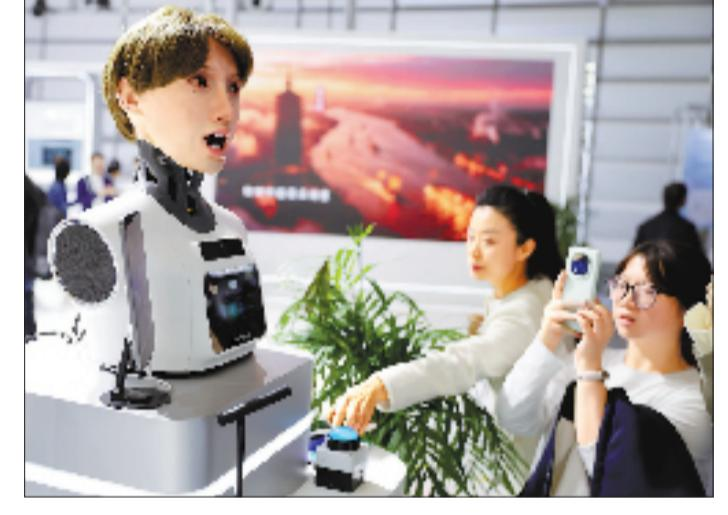
本款仿生机器人搭载高性能处理器，采用自主研发的仿生皮肤和高精密执行器，结合仿生人本体与控制算法，实现精准的表情模拟与动态交互。它可以模拟人类85%的面部表情，可实时识别并模仿愤怒、微笑、厌恶、轻蔑、吃惊、伤心、思考、大笑等复杂表情；集成大语言模型，支持表情与语音同步、性格设定及多语言交流，支持自定义机器人设和音色等，能够准确识别语音指令、理解语音语调、情感和语境，人机交互对话时延小于1600毫秒。
