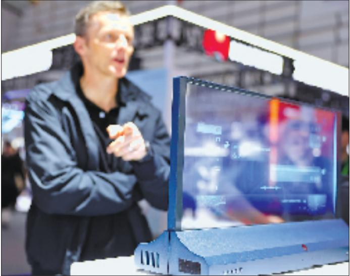
该设备采用双面透明屏设计，集成语音识别、语音合成及星火大模型技术，旨在解决机场、地铁站、酒店和旅游景点等公共服务窗口的跨语言交流问题。在对话翻译模式下，该设备支持38种语言的语音识别与互译，搭载大模型的自动识别能力，无需手动选择语种，并支持语音播报。在无人值守场景下，提供数字人客服模式，当诉求超出智能问答的范围时，可以一键呼叫远程人工客服。采用最新的多模态降噪技术，即使在嘈杂环境中，也能有效提升语音识别的准确度。
