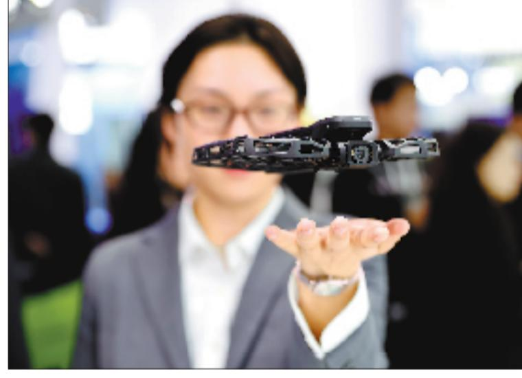
该相机实现“零门槛”操作，无需遥控，3秒手掌起飞，重量约192克，具备5级抗风能力，支持最高40公里/小时的匀速跟随。在开启全地形飞行模式后，能够在水面、雪地、悬崖等复杂环境中稳定飞行。在影像技术方面，其配备1/1.3英寸CMOS传感器和定制的7层镜头，可拍摄8K视频，提供14档动态范围和107°广角视野。得益于可选配的耐寒电池，它可以在零下20℃环境下稳定运行，续航约16分钟。为运动爱好者和专业内容创作者提供前所未有的超低空、超近距、高速跟随的视角。
