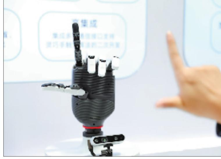
它是国内首款腕手一体双绳驱全仿生五指灵巧手，拥有22自由度仿生架构，双绳驱动系统、腕手协同控制技术和端侧算力四大核心创新。通过巧妙的结构设计，实现手指的弯曲、伸展和双向侧摆的主动控制，增强了主动控制能力、抗干扰能力、稳定性及被动柔顺性。实现手腕前后和左右的摆动，提升灵巧手的操作空间和灵巧度指数。实现手掌的全域感知，在运动精度、抗干扰能力、动态调速方面表现优异。
