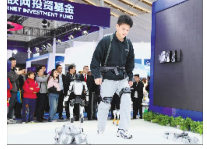
通过腰部助力可节省30%体能消耗，缓解登山肌肉疼痛。这款外骨骼是专为户外运动设计的智能辅助设备，旨在提供稳定、舒适的行走支持。它重2.4公斤，可续航约1万步，最大提供17牛·米的助力。设备支持一键启动，无需复杂操作，具备多档助力调节功能，可根据运动强度和个体能状况灵活切换。据监测，使用后最高心率和平均心率同比下降均超过11%。
