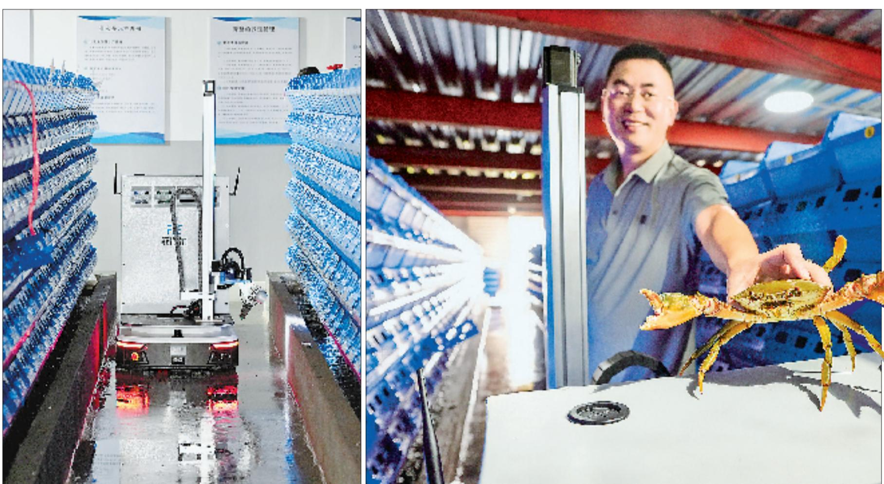
近日,台州丰产水产养殖有限公司车间, AI智能巡检机器人正在巡检青蟹养殖状态。该机器人搭载多类传感器,可24小时不间断监测水温、水质酸碱度、溶氧量等关键数据,并能通过图像识别技术主动识别异常活动及病死蟹,及时预警。这不仅大幅降低了人力成本与劳动强度,更显著提升了青蟹的存活率与品质稳定性。
