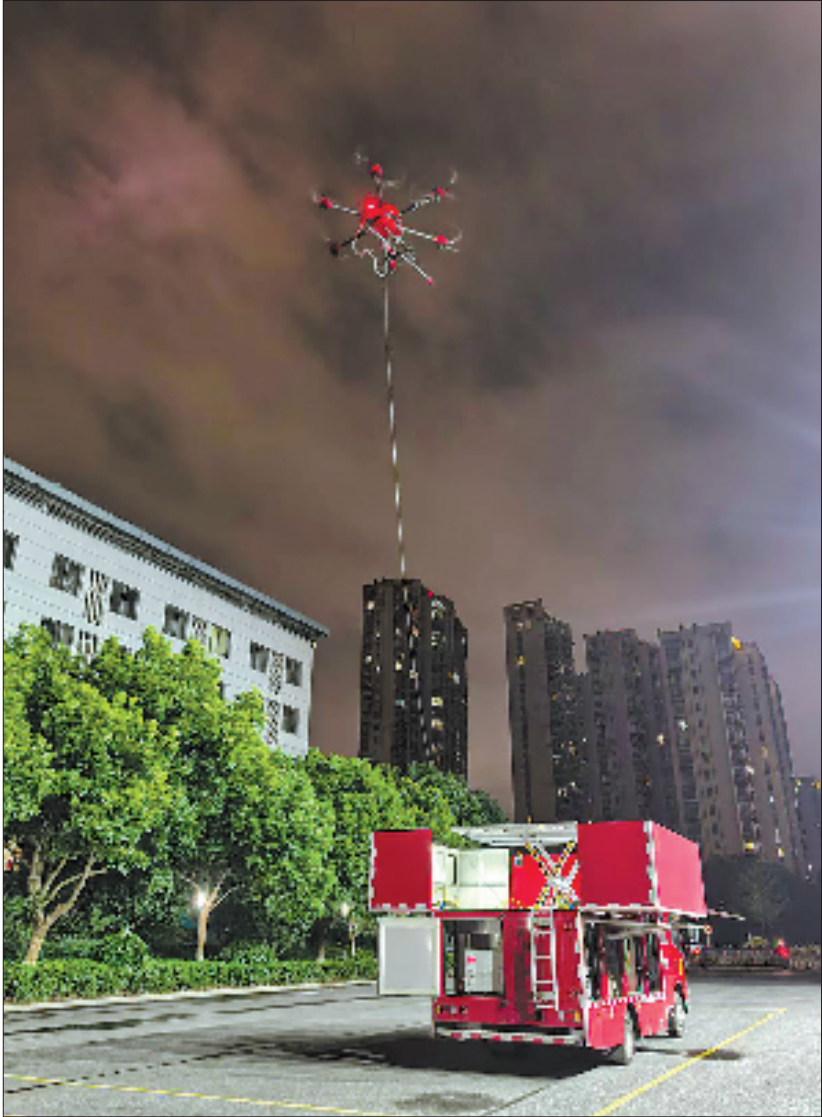
操控员测试车载系留无人机高空灭火系统的飞行高度以及长时间作战能力。
