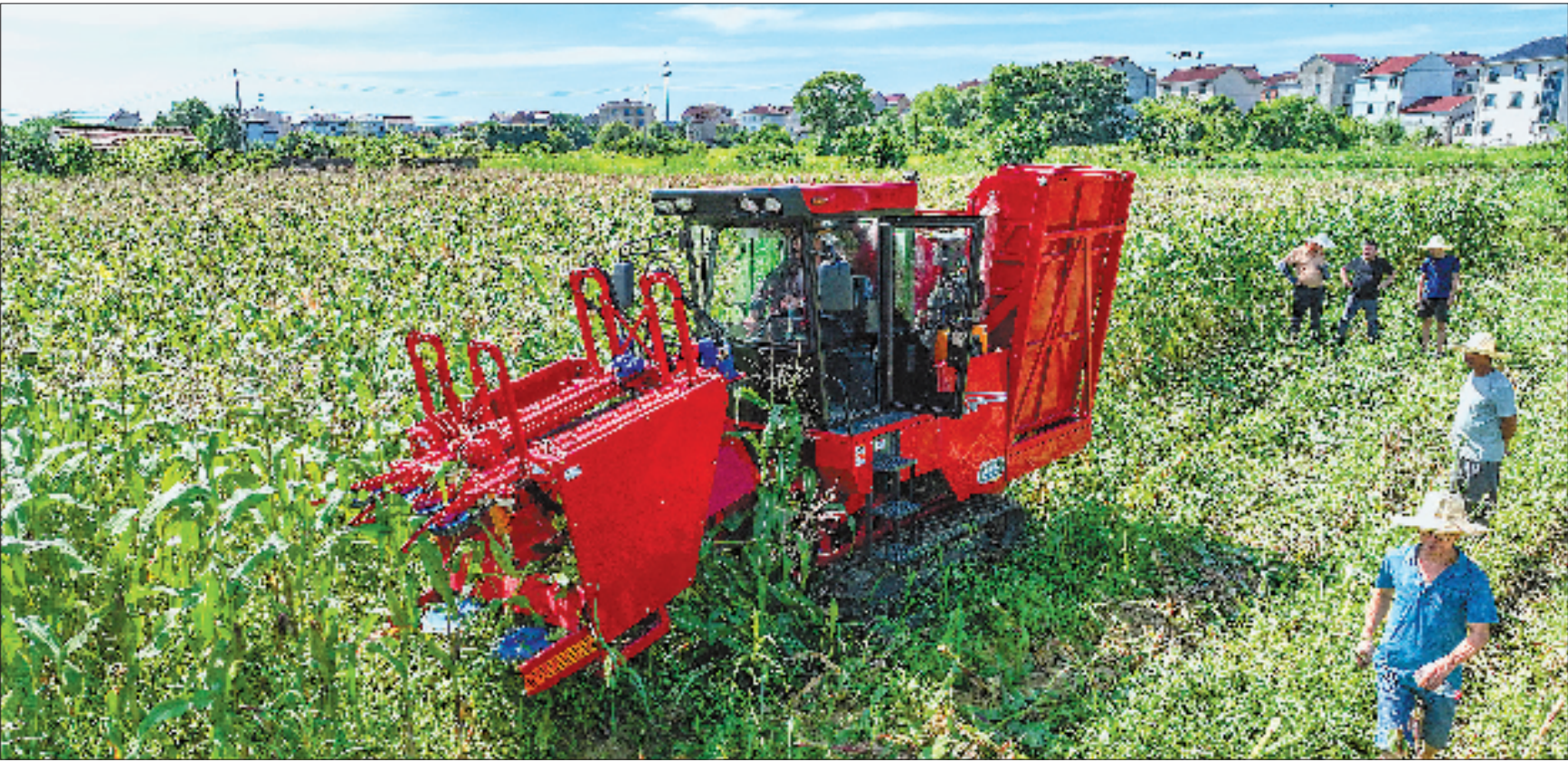
7月2日,我省首台2行自走式鲜食玉米收获机,在金华市婺城区下汪村的一片鲜食玉米地完成田间试验。该装备由浙江省农业机械研究院联合农业农村部南京农业机械化研究所及相关企业共同研制,目前已初步满足作业要求,预计综合作业效率是人工的50倍以上。
