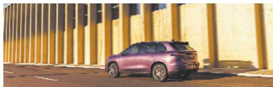
新车采用前麦弗逊后五连杆底盘，经中欧团队联合调校。纯电版搭载220kW电驱，百公里加速5.9秒，电驱综合效率92%。配备LMC一体化运动融合控制技术，120km/h爆胎时500毫秒内可稳定车身，还具备多种稳定
