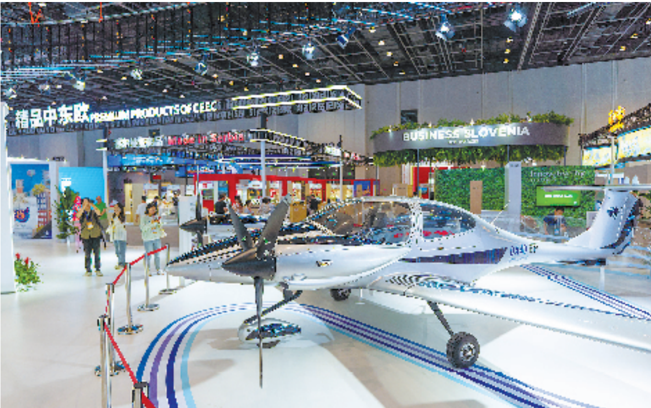
5月21日，“数智中东欧”展区展出由奥地利钻石飞机公司研发的多发混合动力飞机，该飞机由一台燃油发电机和两台电动发动机提供动力。
