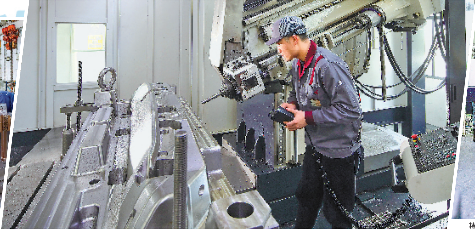
在凯华模具生产车间,工人正对模具进行深孔钻加工。
