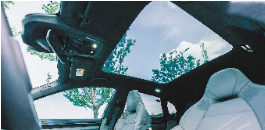
精一新材料生产的智能纳米调光玻璃已应用在新能源汽车上。 本版图片除署名外均由受访者提供
