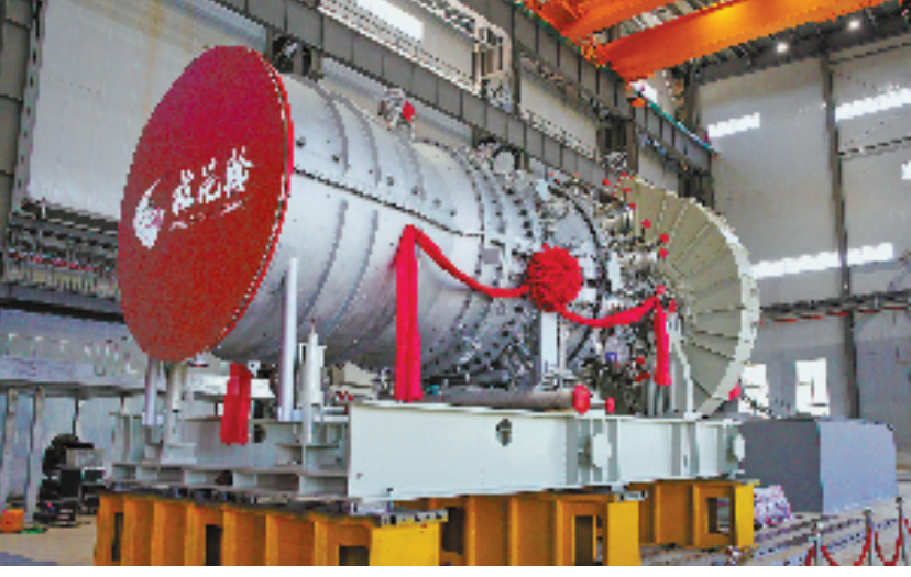
杭州汽轮动力集团自主研发的F级50兆瓦重型燃气轮机HGT51F。
