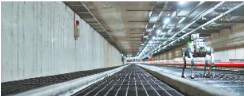
“云深处”的机器狗在新加坡电力传输电缆隧道巡检。
