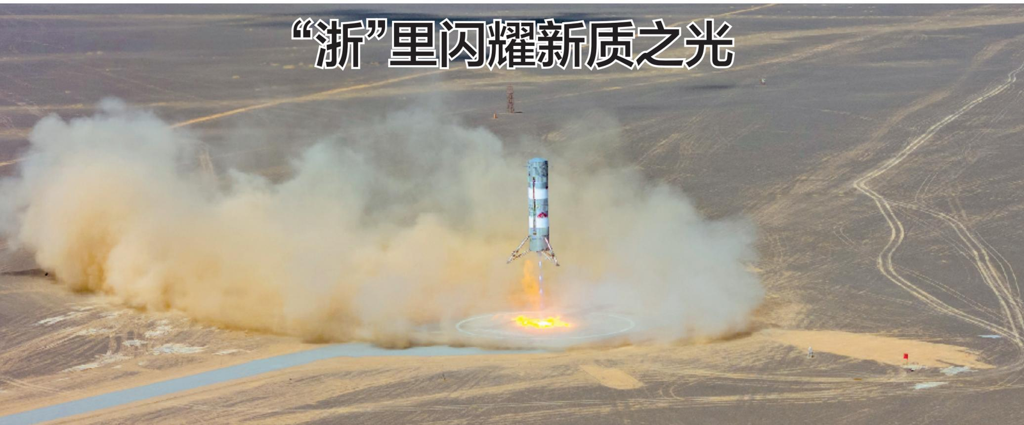
2024年9月11日,酒泉卫星发射中心,浙产朱雀三号VTVL-1可重复使用垂直起降回收试验箭圆满完成十公里级垂直起降返回飞行试验。
