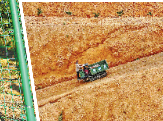
履带式搬运机“爬山虎”在丘陵山地轻松爬坡,即使45度的斜坡也不在话下,运输果疏方便轻松。
