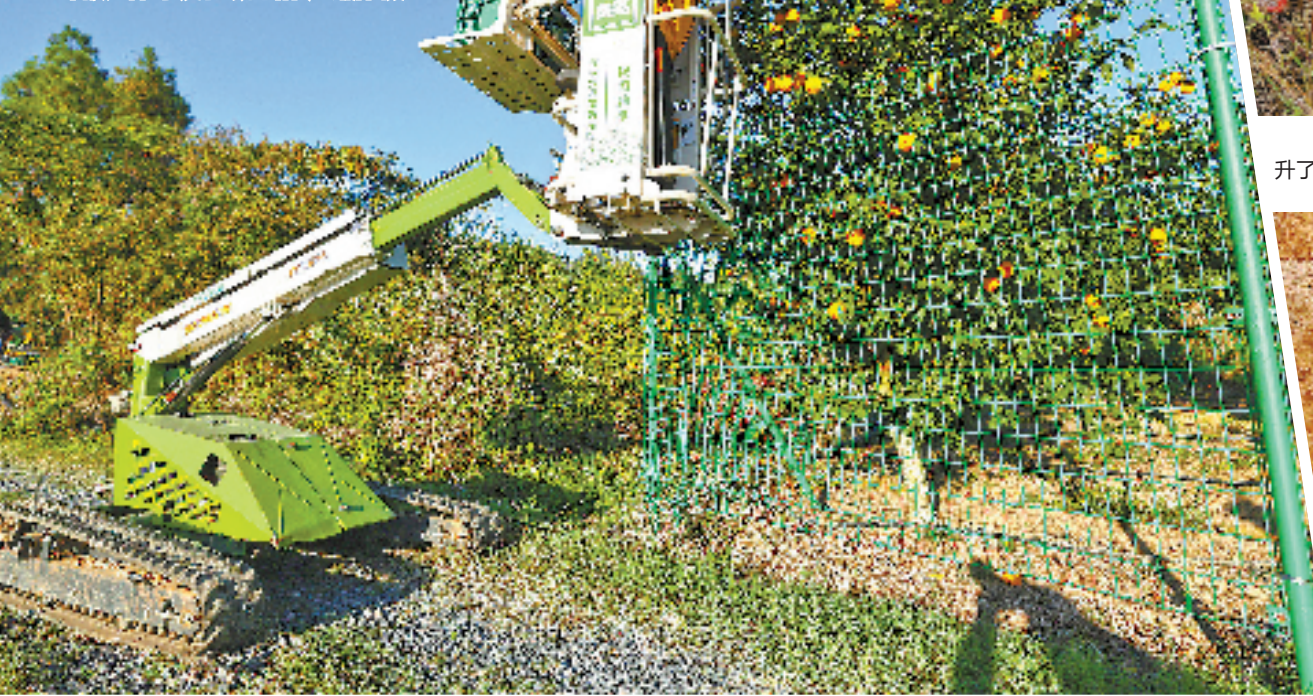
柚农操作升降采摘机采收高处的果实。升降采摘机能够在丘陵山地自由行走,将果农提升至合适的高度,从而方便采摘作业。
