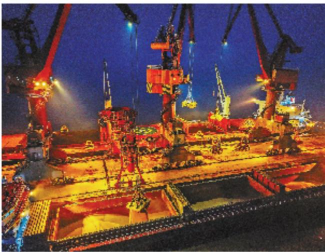
外籍散货船(上)正在宁波舟山港老塘山散货减载平台将大豆减载到江海联运船(下)中(资料照片)。
