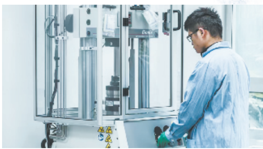
浙江省医疗器械检验研究院检验人员正在用液相色谱力学期疲劳试验机进行脊柱植入器械抗疲劳性能测试
