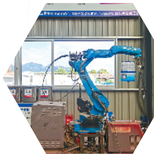
钢筋加工场采用焊接机器人进行焊接作业
