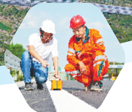
工作人员测量标线的 逆反射系数
