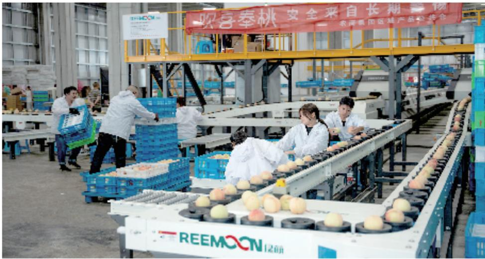
奉化区农商控股集团水蜜桃无损检测分拣线
