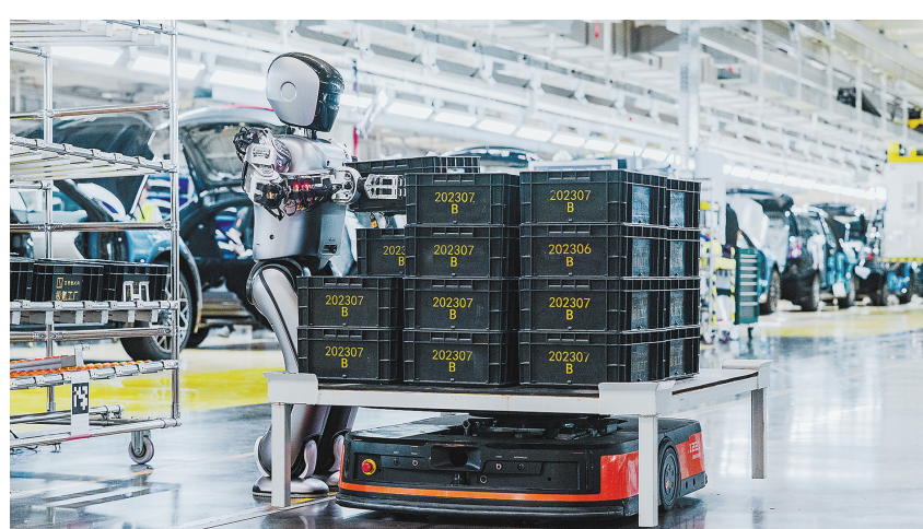
图为位于宁波前湾新区的极氪5G智慧工厂的人形机器人“员工”,可在不同流水线上自主导航和负重行走。
