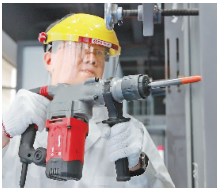
本报“全副武装”,用电锤对防盗门进行防破坏测试。
