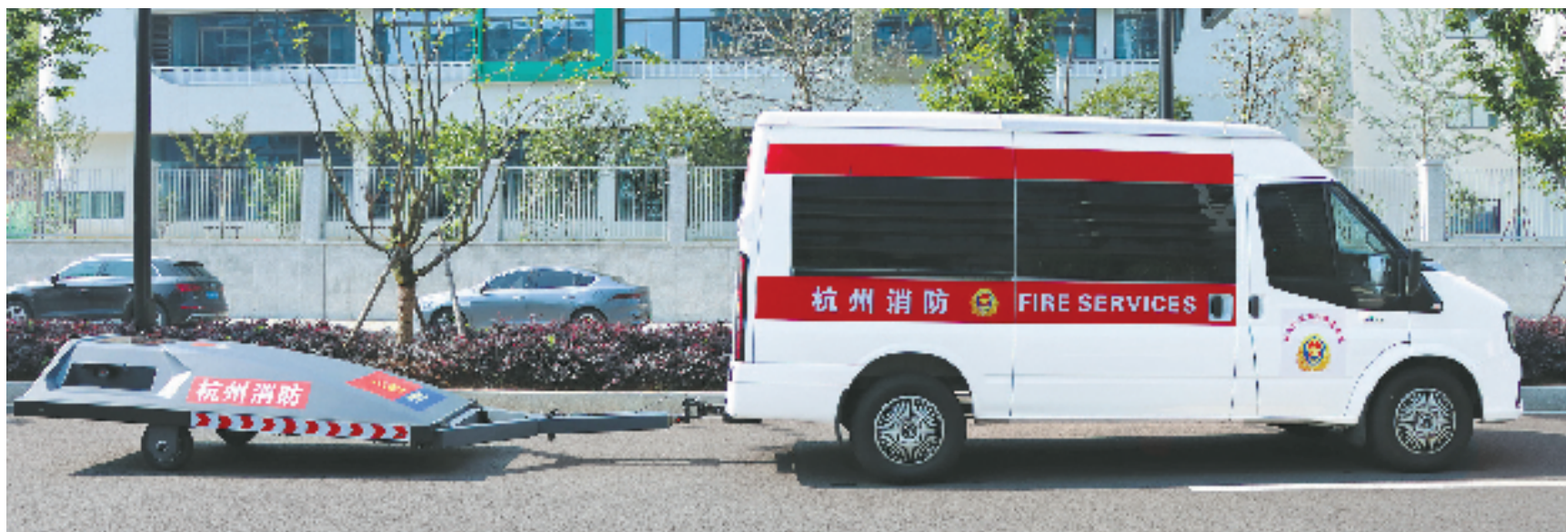
车载拖曳式瞬变电磁道路地下隐患探测技术及装备。
