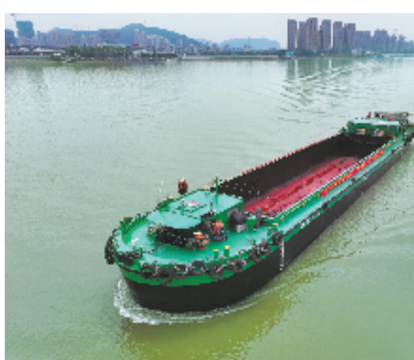
7月11日,浙江省首艘自主设计研发的“油改电”内河货运船舶——浙能集团所属“浙萧山货03306”货船完成改造,在杭州萧山试航成功。该船为锂电池动力,电池容量为1048千瓦时,相当于30辆电动汽车的动力总和。
