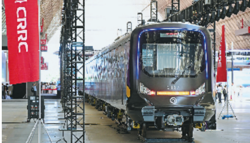
这是碳纤维地铁列车“CETROVO 1.0 碳星快轨”(6月26日摄)。当日,中青青岛四方机车车辆股份有限公司联合青岛地铁集团等单位研制的商业化运营碳纤维地铁列车“CE-TROVO 1.0 碳星快轨”在青岛发布。该车较传统地铁车辆具有更轻、更节能等显著优势,引领地铁列车实现绿色升级。
