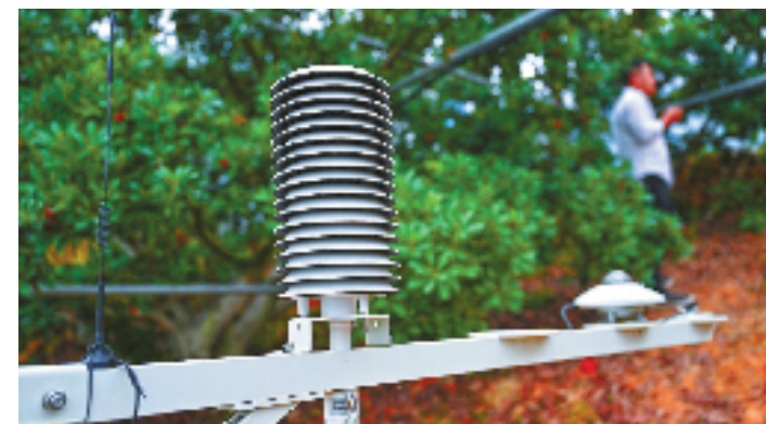
大棚装上了气象数据监测系统，精准控制大棚内的温湿度。
