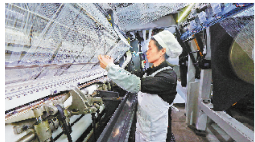
浙江移动与真爱裘业公司共同创新,打造“5G+AI家纺纱质质检”解决方案,为每台经编机配置工业相机,应用AI视觉质检,生产效率提升了3倍,产品优品率也有了更好地把控。
