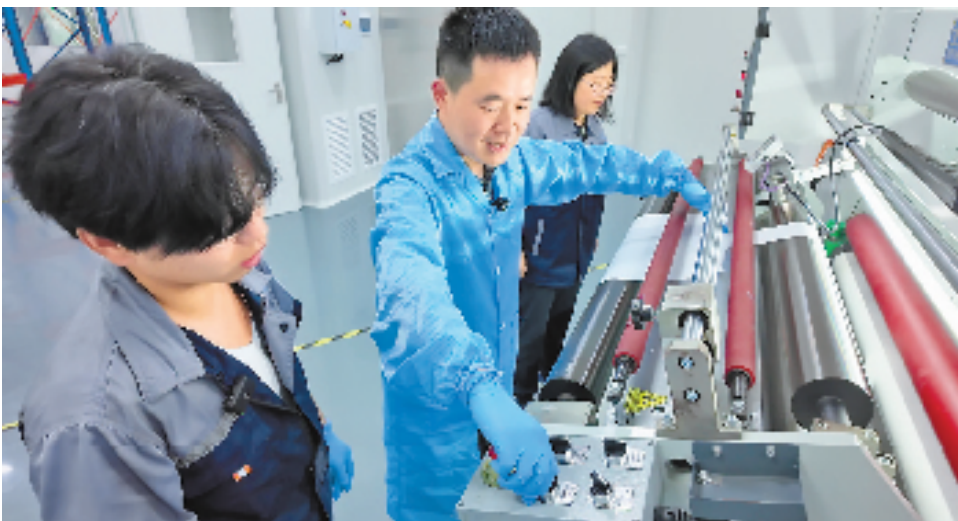
记者(中)尝试对纳米纤维膜进行后道加工。
