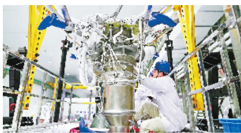
4月26日，在位于湖州南太湖新区的蓝箭航天发动机总装工厂，技术人员在组装国内首款百吨级液氧甲烷发动机——天鹊发动机。截至目前，天鹊发动机已完成30余台子样考核，关键技术已全部突破，总装工厂正在加大力度投入生产。 本报记者 李震宇 拍友 项飞 摄
