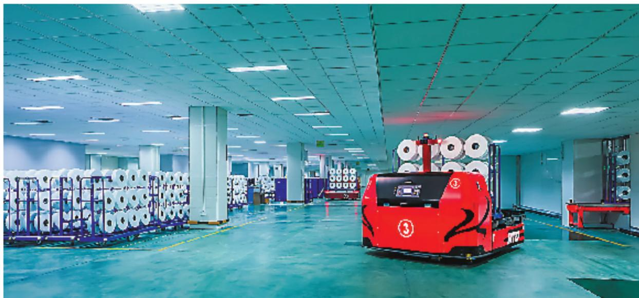
义乌华鼎五洲锦纶纤维“未来工厂”里,AGV无人运输小车在自动导航指引下精准配送物料。
