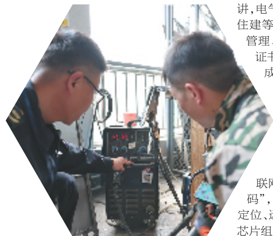
电气焊设备实现“一芯一码”，以“码”管机，武义县应急管理局工作人员正在检查设备码。 沈立 摄
