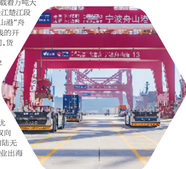
无人集卡在金塘港区大浦口集装箱码头作业
