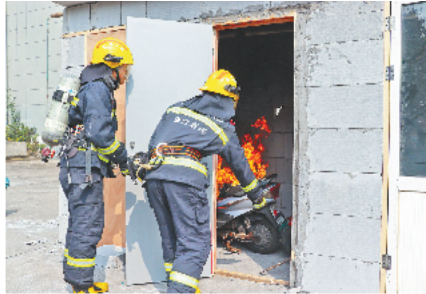
正确使用防火门能在一定时间内有效阻隔火势和浓烟的蔓延，为人员避险、疏散逃生争取更多的时间。近日，嘉善县消防救援大队在一家空置厂房内做了一次关于如何正确使用防火门的对比实验，向群众宣传选择安装合格防火门的重要性。
