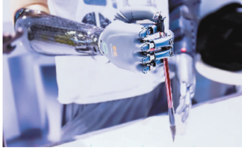
强脑科技的智能仿生手可实现5根手指、手腕的独立运动。图为仿生手正在练习书法。
